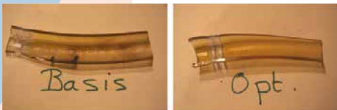
Figuur 3: Effect van de bedrijfsvoering op de vorming van biofilm in de waterleidingen
